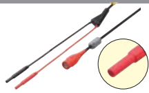
L9790 连接线 最大可输入600V，柔性线径 φ4.1mm，线长1.8m，※前端 夹具另售
