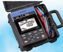
IR3455电子式绝缘电阻表 绝缘电阻测量最大10TΩ，试验电压范围250V~5kV。
